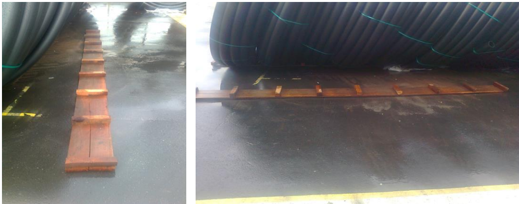
Figura 16 – “Trava-rolo” de madeira, que deve ser posicionado abaixo dos rolos.
