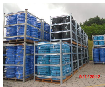
Figura 14 – Armazenamento de KanaLiso DE 20 e 32 mm em rack's desmontáveis.
